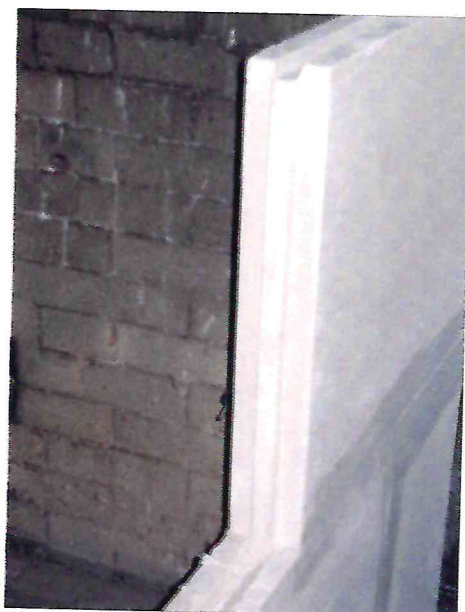
Фото №1,2. Плиты гипсовые для перегородок ПЛГ 667х500х80. ГОСТ 6428-83, Код ОКП 57421 до и после проведения испытания (фрагмент с обогреваемой стороны).
